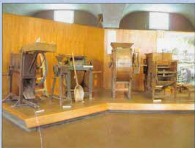
La modanatura. Da destra: sgranatrice per granturco ( sgruna/riss ), mulino a mano ( mulinet ), trebbiatrice per grano ( màchina da bate ) con ventilabro ( glosse ).
