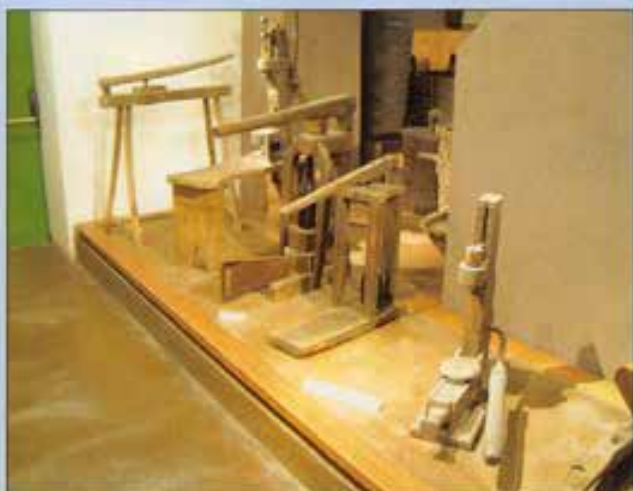
Per l'imbottigliamento del vino si usavano macchine tappatrici di vario tipo, semplici e un po' grossolane ma efficaci.
