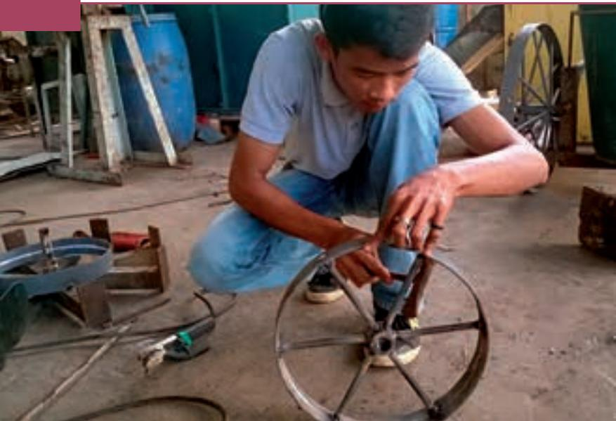
Costruzione di ruote di ferro.
